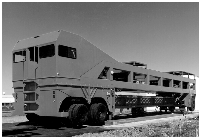
Heavy Vehicle Simulator impiegato per lo studio del Caltrans e del CSIR.
