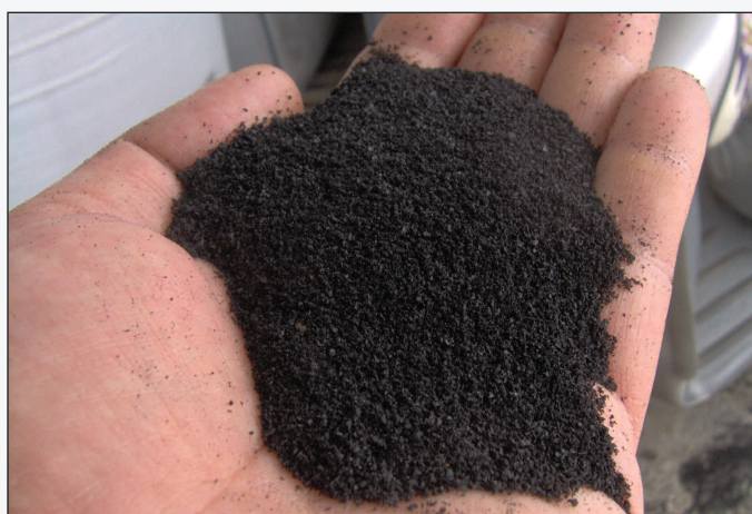
Figura 1 - Il polverino di gomma da pneumatico riciclato (Crumb rubber modifier) impiegato da Asphalt Rubber Italia
