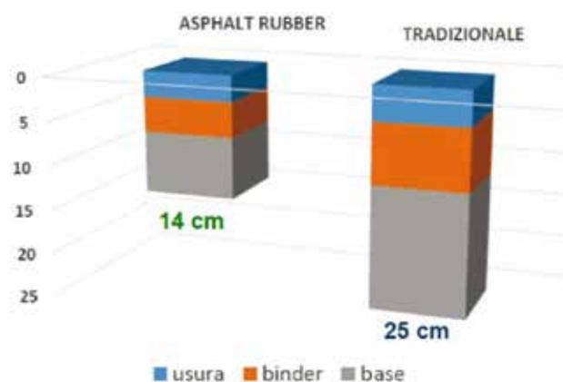
5. La riduzione dello spessore della sovrastruttura stradale nella Variante di Canali (RE)
